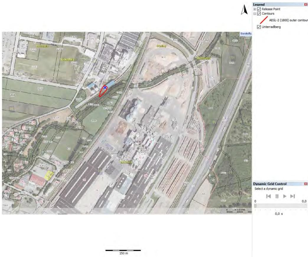
Abbildung 2: Ausdehnung der Schwergaswolke (rot gekennzeichnet den AEGL2 30 Minuten Wert 160 ppm)
