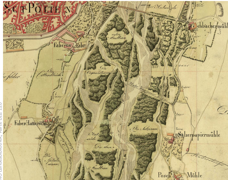
Die Vermessungspläne des Traisen-Unterlaufs aus dem Jahr 1820 zeigen eine noch weitgehend natürliche Morphologie. Die äußerst detaillierten Karten waren eine Grundlage für wasserbauliche Maßnahmen der folgenden Jahrzehnte.
